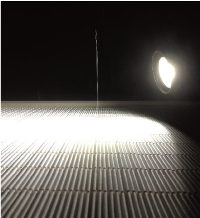
Fil di fumo - prova rilievo microperdite - EN1822-4 (Annex A)
