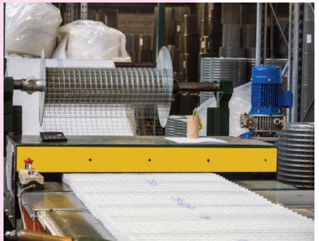
Ondulatrice a passo costante e regolabile
